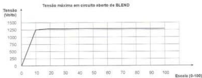
FIG 17 – Tensão Máxima em Circuito Aberto de BLEND
